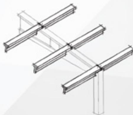
Sekundarni nosači su prednapregnuti ili klasično armirani elementi. Predstavljaju se kao krovna konstrukcija. Izrađuju se od betona klase C $\geq$ 30/37 i različitog su tipa utezanja, u zavisnosti od statičkog proračuna. Dimenziije poprečnog preseka su date tabelarno i zavise od raspona i pripadajuće površine. Sekundarni krovni nosači naležu na glavne nosače krovne konstrukcije.
